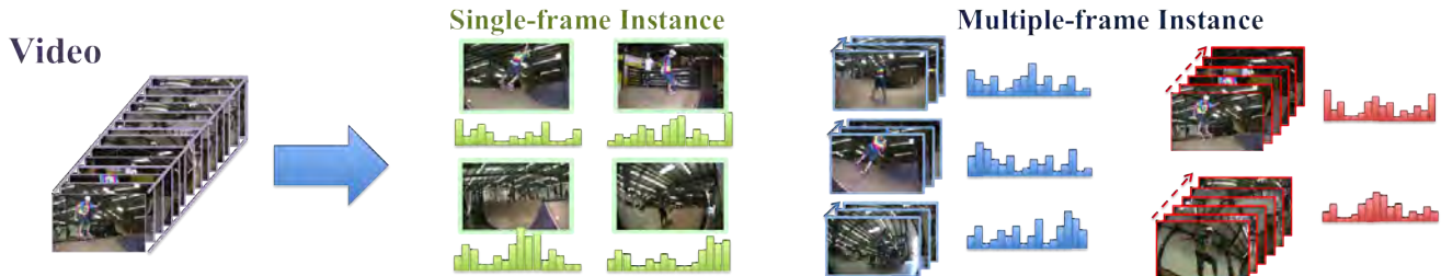
图2.图示具有不同时间长度的多个粒状实例。在我们的框架中，最小粒度的实例是一帧，并且最大粒度的实例是整个视频。每个实例都由包中包含的帧级弓表示。
