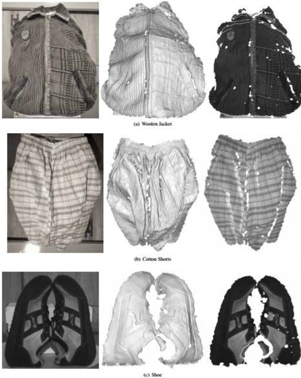
图 6, 一些复杂的多反射率对象的重建。左: 红外图像, 中间: 我们的三维重建, 右: 我们估计的相对反射率。
