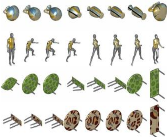
图 3. SHREC'13 的 4 种不同样本的基准类[8], 并且需要具有不同结构和变形。对于每个 Null shape, 有所改变的地方, 包括非刚性的变形、非度量保留变形、附加的高斯噪声扰动
