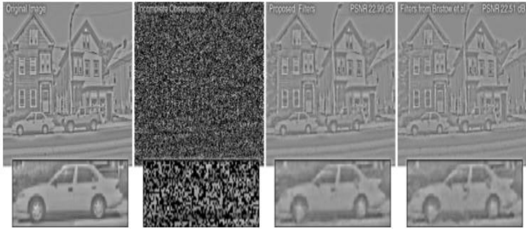
图 6: 修复的例子表明: 原始图像 (左), 随机抽样的不完全观测 (中间偏左), 重建了 \mathbf{f}_i 滤波器算法 (中右), 和 \mathbf{f}_i 滤波器从 [ 3, 4 ] (右)。除了这个例子, 我们评估了一个更大的数据集在图 7 的重建质量。
