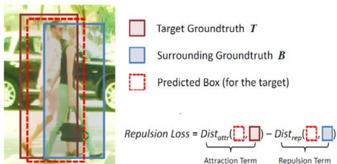
图1. 我们所提出的排斥损失的例证。排斥有两部分组成：目标的吸引力将提议的结果和特定目标的差距缩小；对周围物体的排斥使结果和非目标物体的差距扩大。
