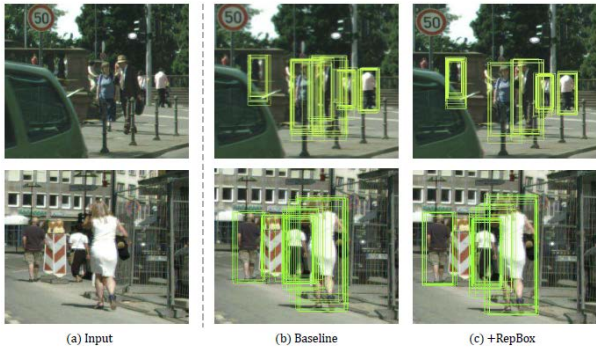
图7. 在NMS之前的基线与RepBox的预测框的可视化比较. 在RepBox的结果中, 两个相邻的实际标准对比之间存在较少的预测, 这在人群检测中是被期望的. 更多例子详见补充材料
