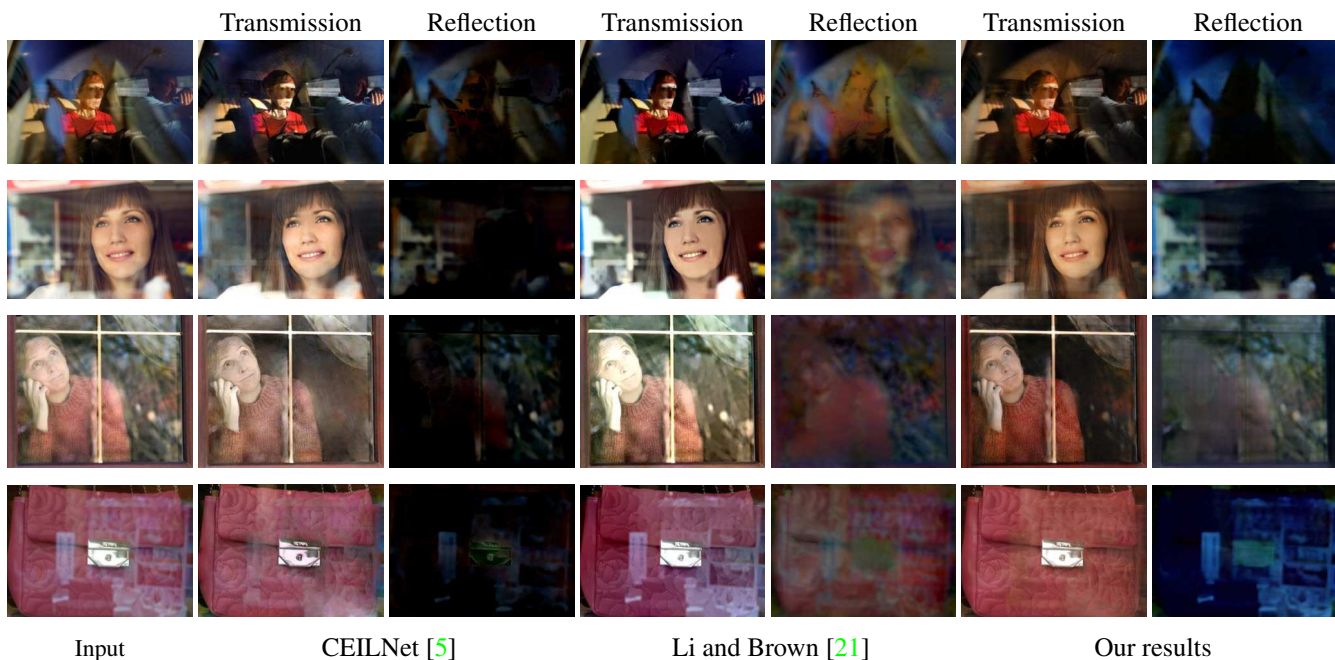
图6: CEILNet [5], Li和Brown [21]以及我们的方法之间的定性比较, 在CEILNET数据集中的真实图像上进行了评估。 请注意, 即使我们对实际数据的反射层没有监督, 但我们的方法也预测了更清晰的反射层。 补充剂中提供了其他结果。
